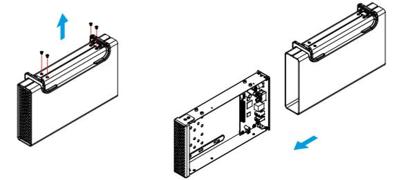
b) Installieren Sie die Festplatte, verbinden Sie das SATA und Stromkabel und befestigen Sie die Platte mit den vier Schrauben von der Unterseite.
