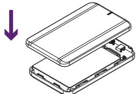
b) 順著箭頭方向，將上蓋朝USB連接埠的方向滑動，使得上蓋固定。
