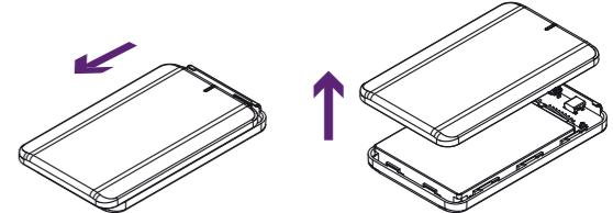
b) 將硬碟安裝至外接盒中。安裝時，先連接傳輸端部分，再輕輕地將硬碟下壓，直到感覺硬碟已完全嵌入外接盒中。安裝後，請確定硬碟已平貼外接盒底部。
