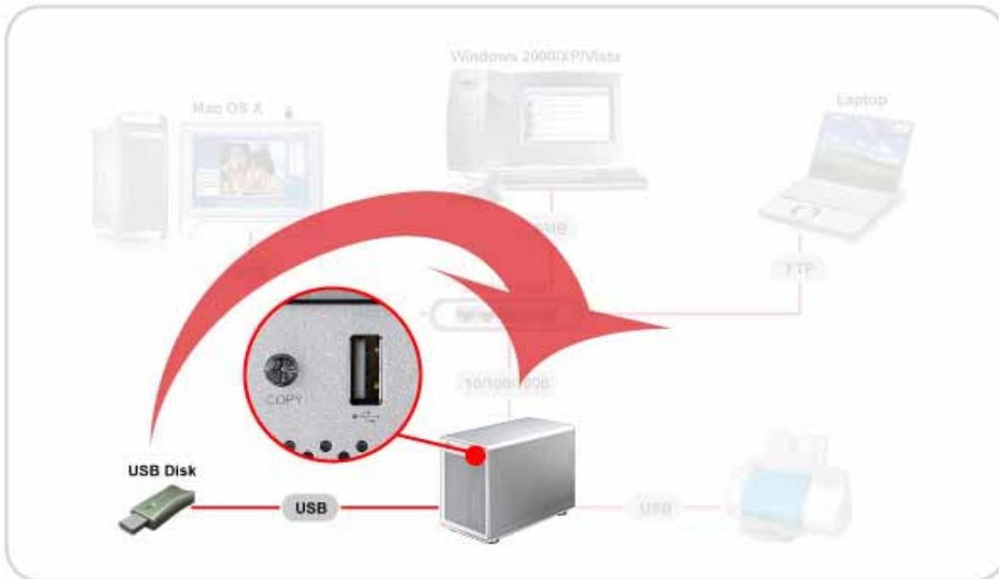
1. 將 USB 磁碟 (檔案格式必須為 FAT32) 插上前面版的 USB 接孔，並等待約 10 秒鐘來裝載本 USB 磁碟
